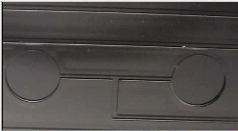
MUSA-2000: micro-FIA em SU-8 sobre silício (canais 100 \times 100^3 \mu\text{m} )
